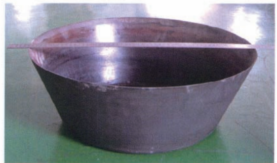
图7 半锥角22°的钛合金普旋零件
