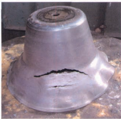
图3 已变形锥体被拉裂现象
