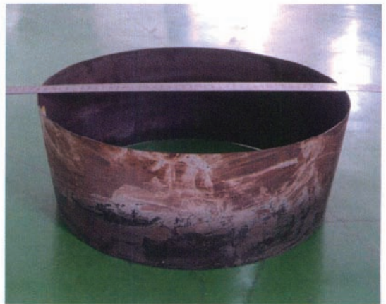
图8 半锥角5°的薄壁曲母线钛合金普旋零件 (切掉筒底与凸缘)
